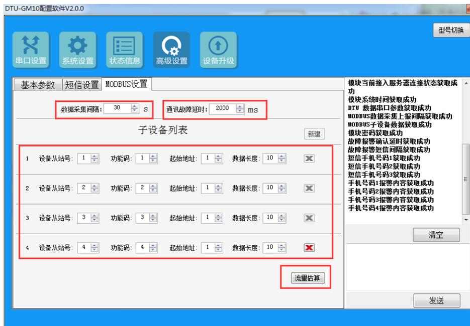
“数据采集间隔”：为模块读取设备数据并上发平台的时间间隔，该值最小为 10 秒，用户需根据自己的需要设置此值。在调试阶段建议设置成 10 秒这样在平台 ( web/APP ) 数据的更新时间会缩短，便于调试监控。测试完后根据所需适当加大时间长度，时间越长所耗
