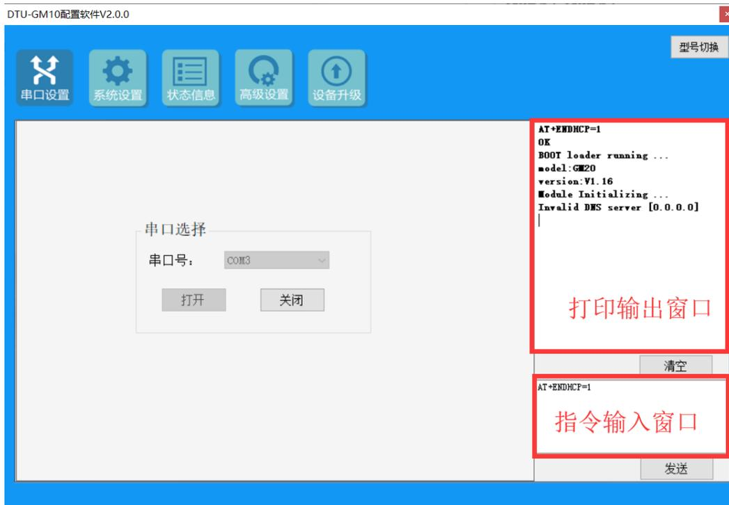
第四步: 在右侧【指令输入串口】按 AT 格式“AT+STAIP=<IP>,<子网掩码>,<默认网关>,<DNS IP>”并回车来输入要设置的静态 IP 参数。
