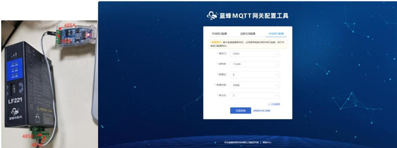
使用 485 串口进行本地配置，将网关的 RS485 口使用 USB 转 485 线接到电脑上，填写配置参数，包括选择通讯口，波特率，数据位，数据校验，停止位。**默认参数为 115200, 8, 无, 1。**
