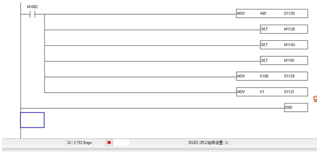
台达 PLC 内部集成了 MODBUS-RTU 功能，按如上对 COM2 口的通讯设置就完成了台达 PLC MODBUS 从站的建立。
