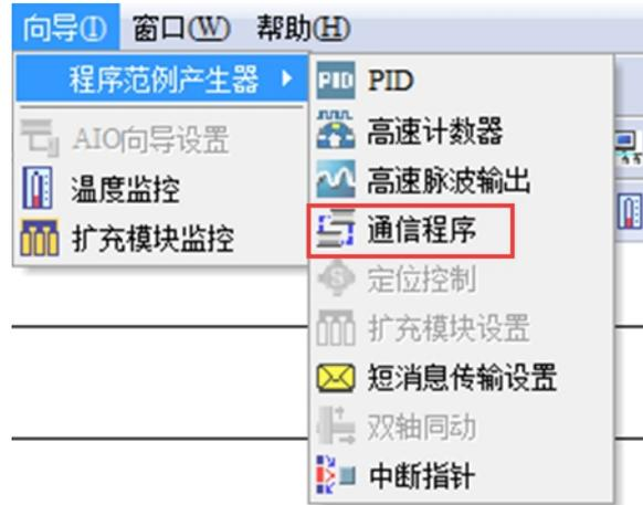
进入 COM 口参数选择界面, (某些型号会让您选择设定的 COM 口, 选择自己要连接 EG20 的 PLC 串口, 这里我们选择 COM2) 选择完 COM 口后点击“下一步”。设置 COM2 串口参数进行如下图设置。确保设置无误后点击“下一步”,
