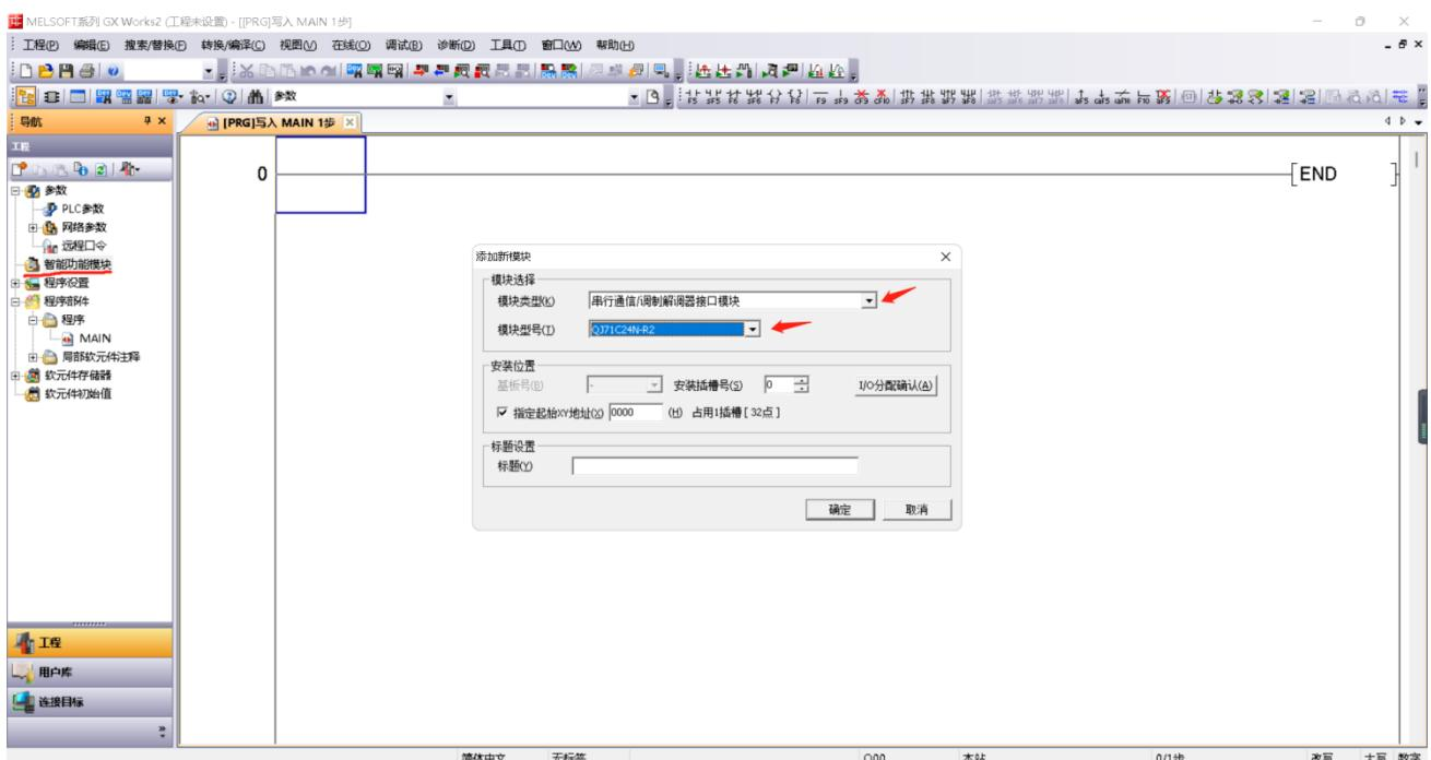
创建完成之后选择开关设置，自行设置参数，通讯协议设置选择 MC 协议（目前不支持格式 5），自定义设置站号，设置完成把智能模块参数下载到 PLC，断电重启 PLC 生效。
