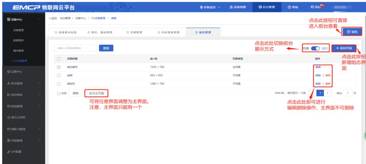
点击界面中间的组态界面列表后方的【编辑】项，进入编辑页面。通过组态编辑页面我们可以任意绘制图片、文字、数显框、按钮、指示灯、管道、设备等控件，详细功能请参考《EG 设备组态编辑使用说明》。
