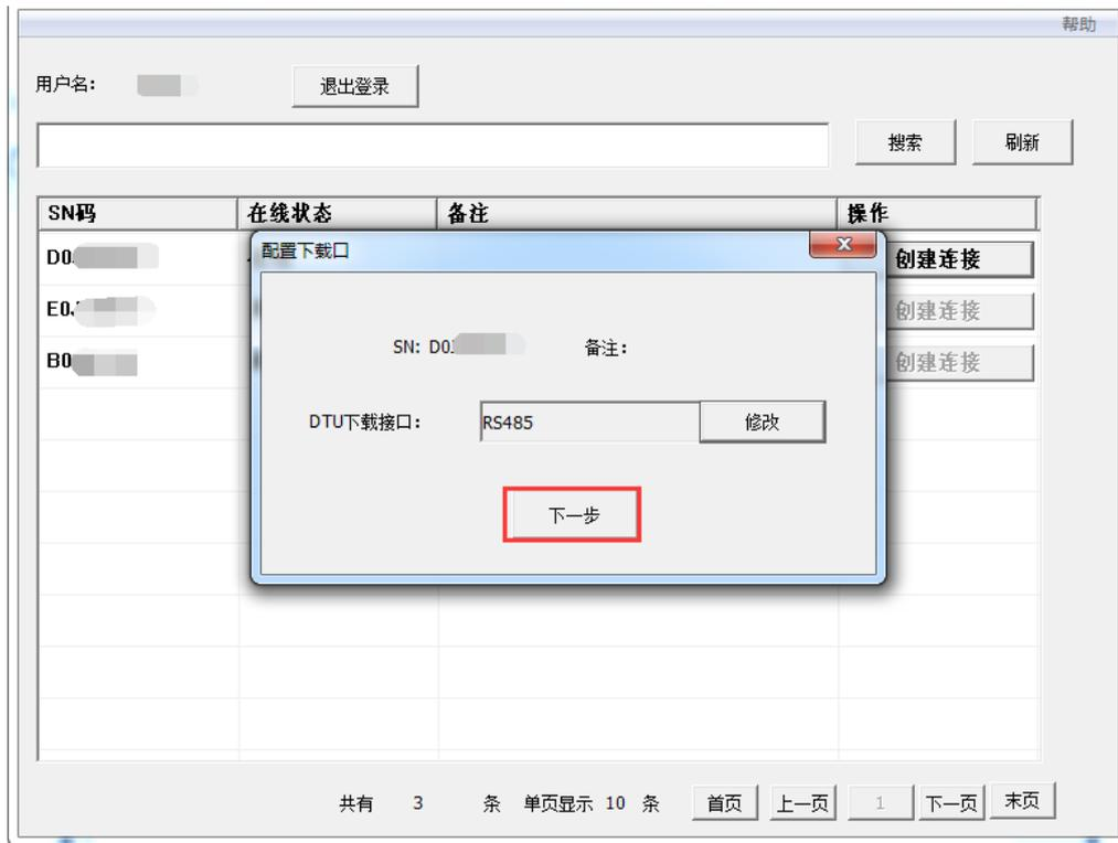
点击【下一步】，在串口配置页面，第一步，在生成的两个虚拟串口中选择任意一个，如图此处选择的为【COM16】，另一个虚拟串口由 PLC 编程软件使用；第二步，设置串口参数，此处设置的为数据网关的串口参数，一定要与 PLC 的串口参数一致；第三步，设置完串口参数后，一定要点击【保存参数】，保存后，串口参数才能生效；最后一步，点击【开始连接】。如图所示，
