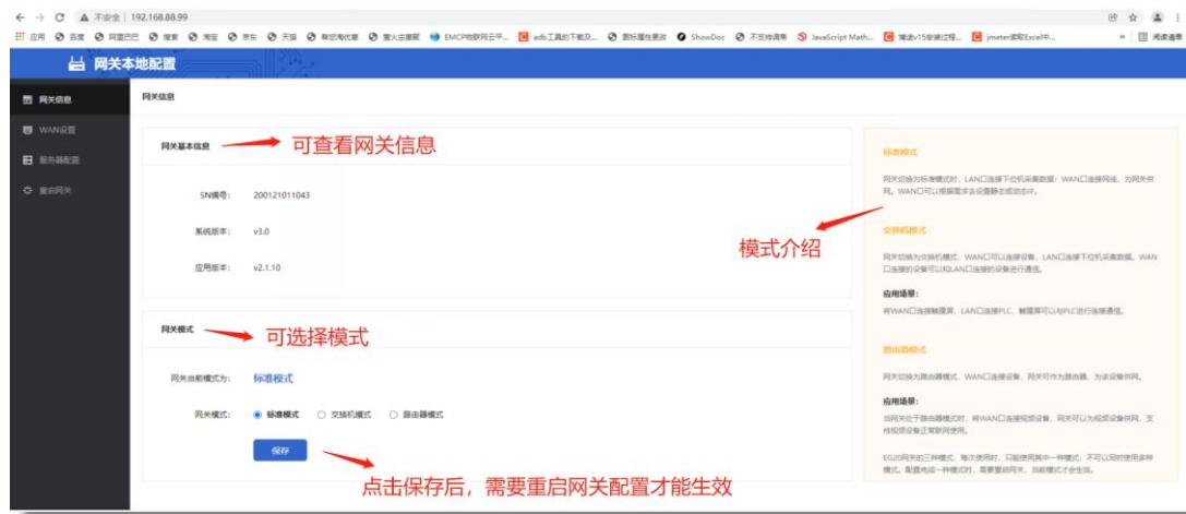
**标准模式（默认）：**EG20 的 WAN 口用于网关联网登陆平台，LAN 口用于和下位机设备（PLC，触摸屏等）进行通讯。WAN 口默认是自动获取 IP 的方式，也可以根据现场的实际上网需求将 WAN 口调整为固定 IP 的方式。
